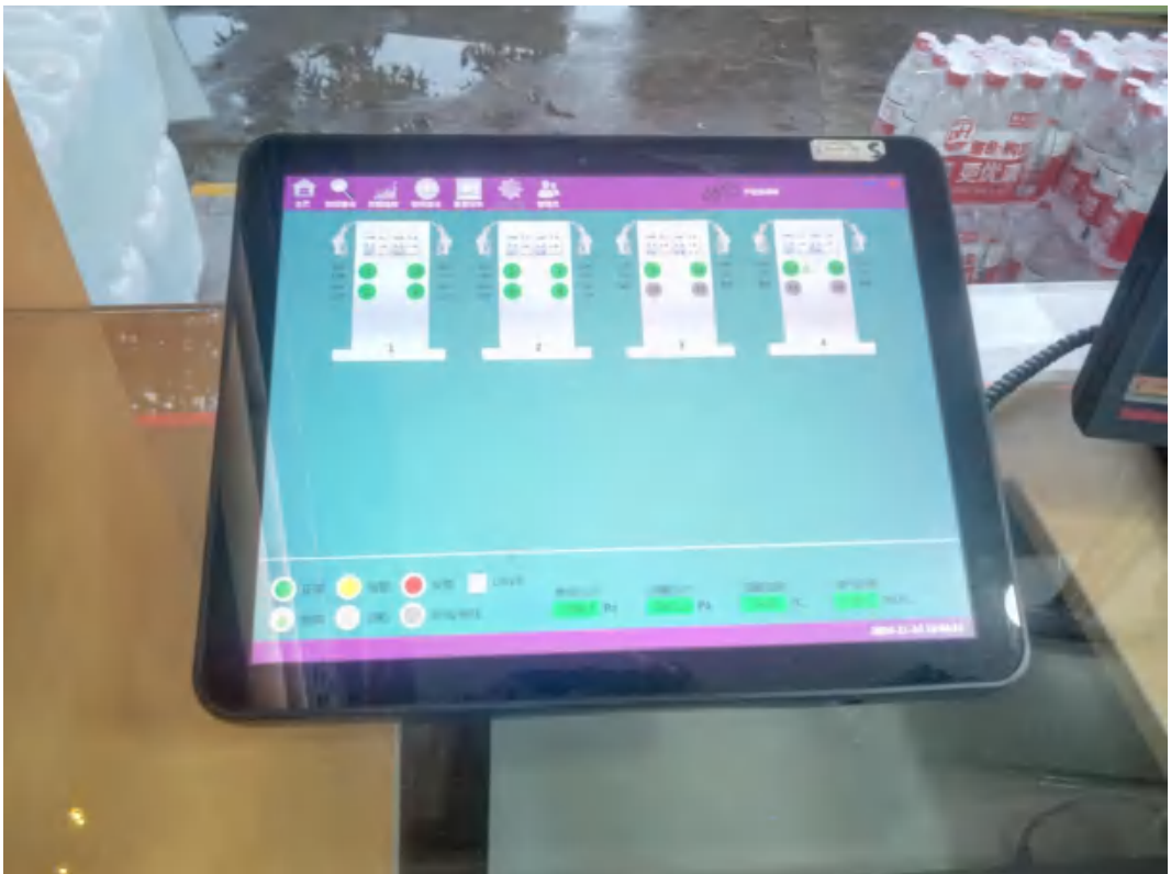
油气回收在线监控系统图片
