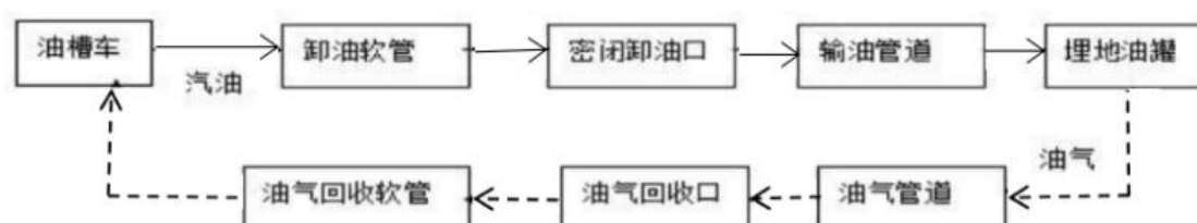
图 2.4-1 汽油卸油工艺流程
