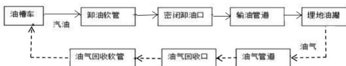
图 2.4-1 汽油卸油工艺流程
