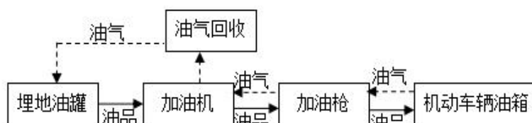
图 2.4-3 汽油加油工艺流程图
