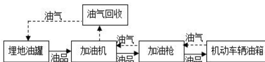
图 2.4-3 汽油加油工艺流程图
