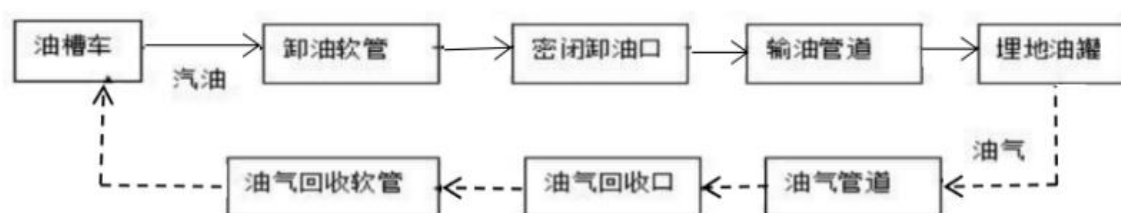
图 2.4-1 汽油卸油工艺流程
