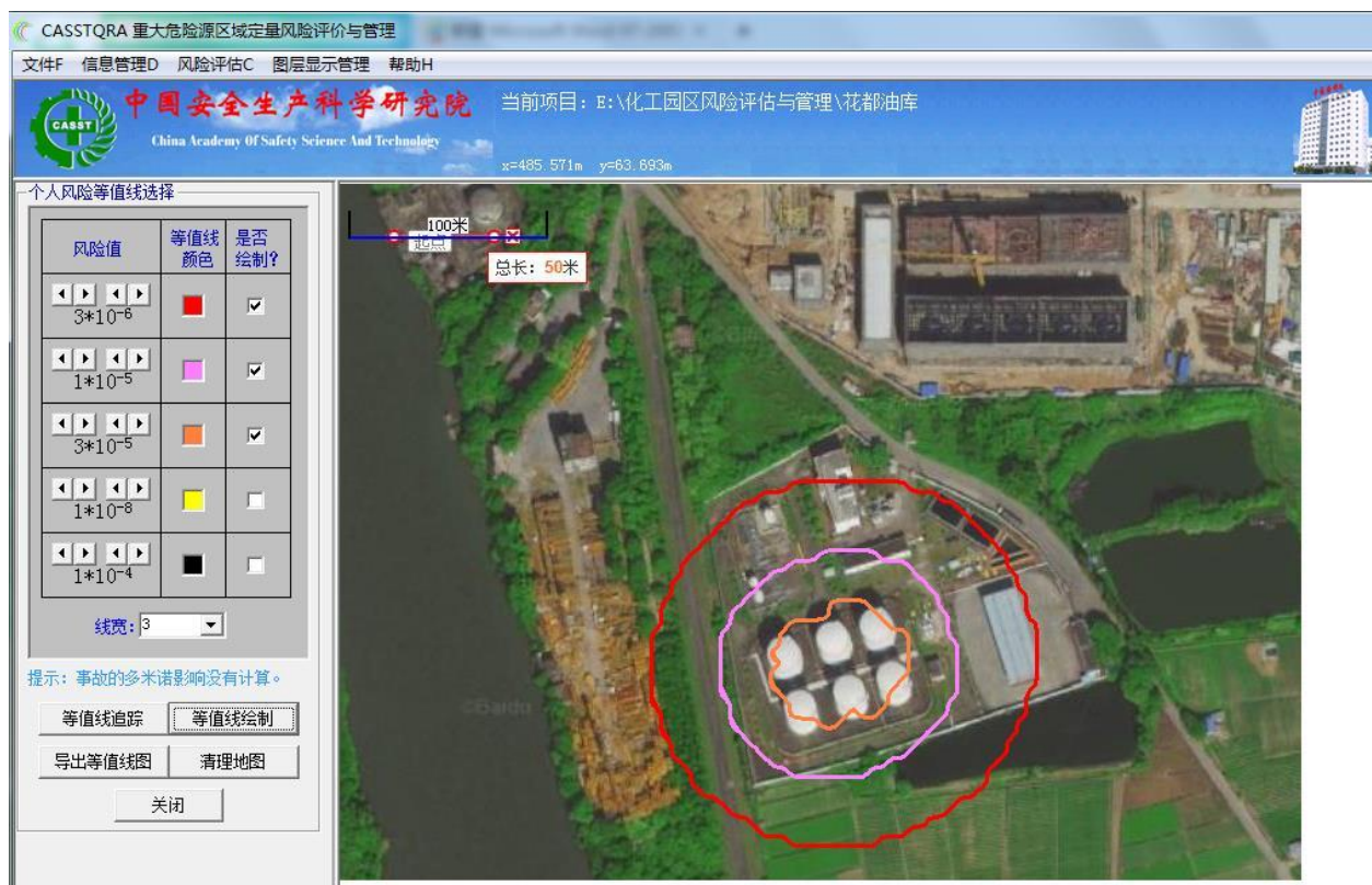
图 7.2-8 储罐区个人风险等值线分布示意图
