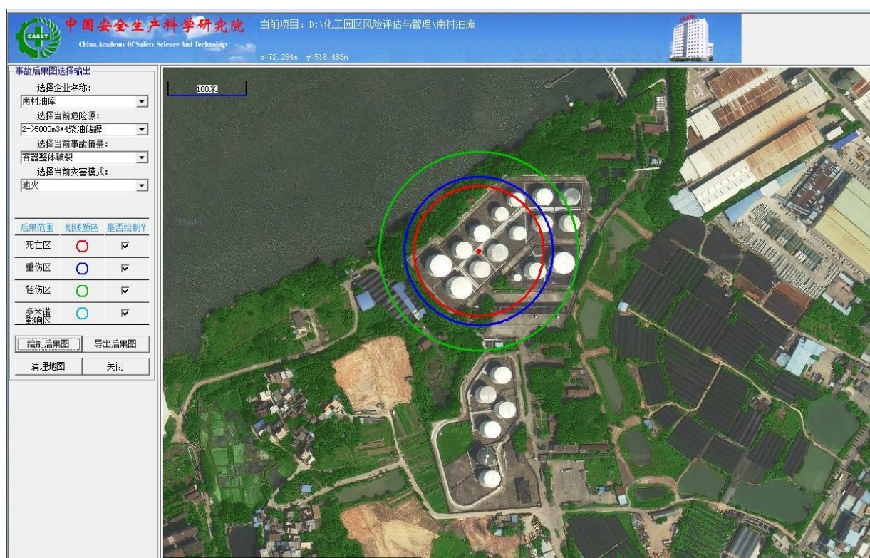
图 8.2-3 容器整体破裂池火事故后果图
