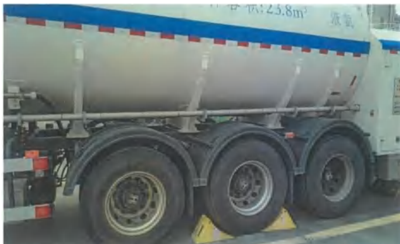
图 2.11-2 驱动轮放置车轮三角木
