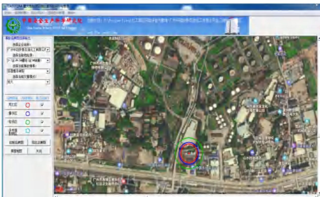
图 7.2-11 金 3#储罐（300 立方米）容器整体破裂事故后果图
