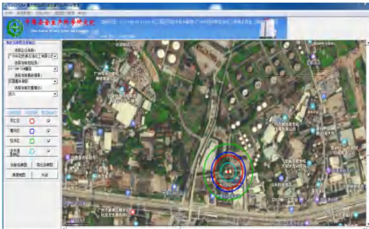
图 7.2-13 9#~10#罐组（2×1000 立方米）容器整体破裂事故后果图
