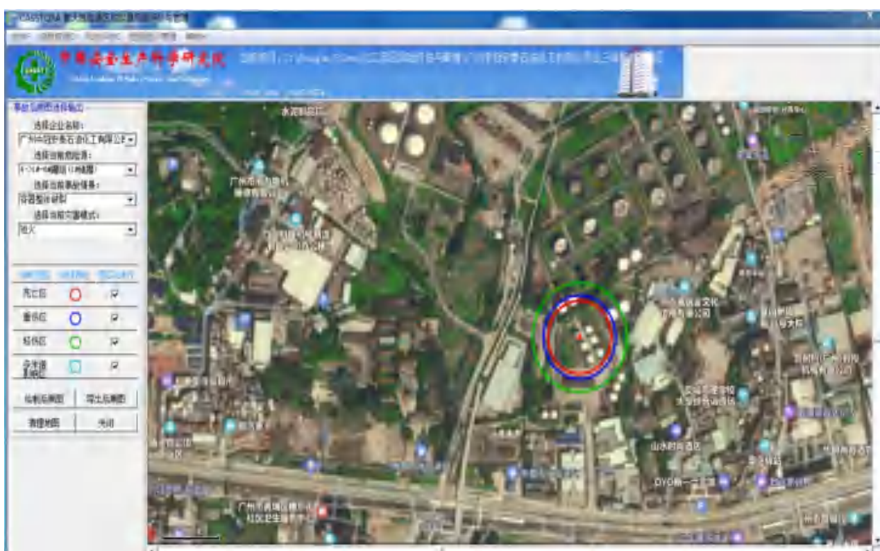
图 7.2-12 1#储罐（1000 立方米）容器整体破裂事故后果图
