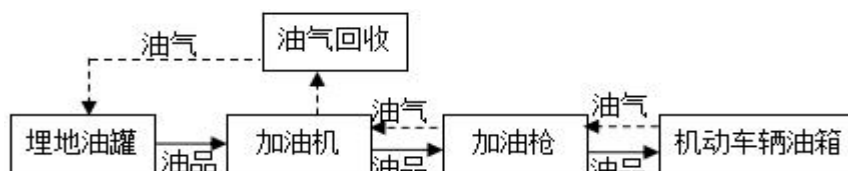
图 2.6-3 汽油加油工艺流程图
