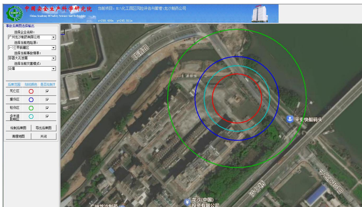
附图 2.4-2 三甲胺罐区储罐容器大孔泄漏云爆模型影响范围图
