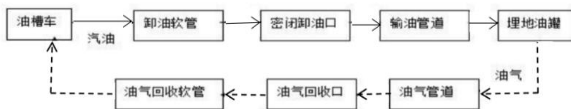
图 2.4-1 汽油卸油工艺流程
