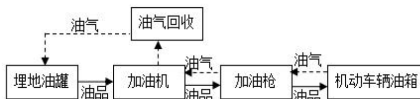
图 2.4-3 汽油加油工艺流程图
