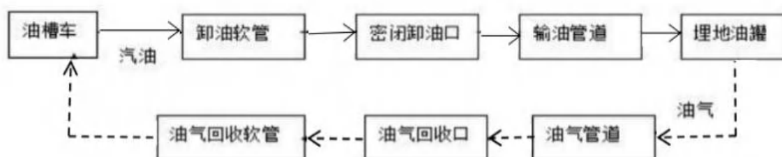
图 2.4-1 汽油卸油工艺流程
