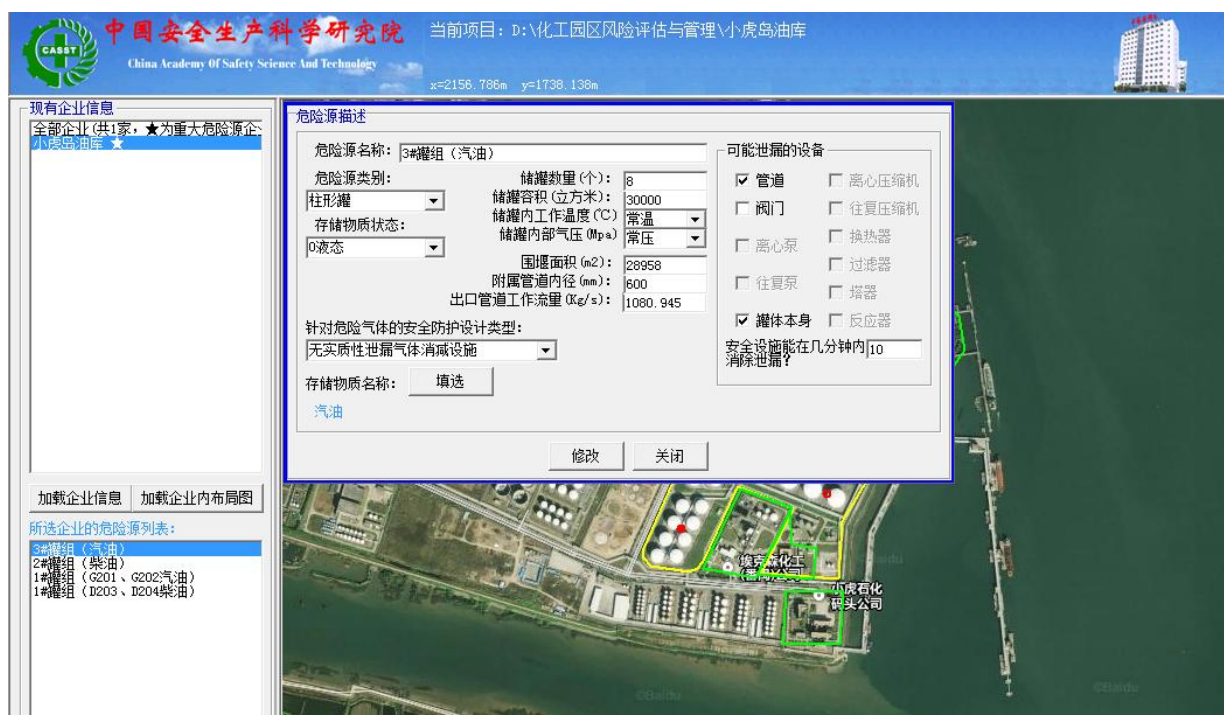
图7.3-6 3#罐组（汽油）储罐参数
