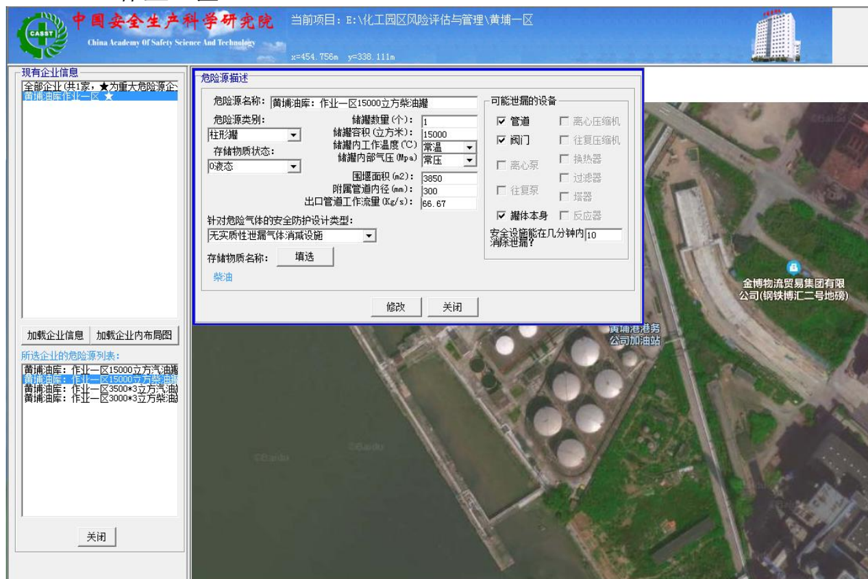
图 7.3-1 作业一区 15000m³汽油罐事故后果模拟参数
